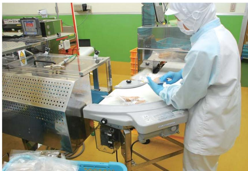
作業を効率化するためにサイズの大きい金属探知機を導入
