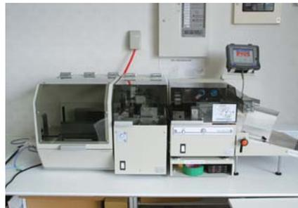
包装資材に直接プリントするサーマルダイレクトプリンター
