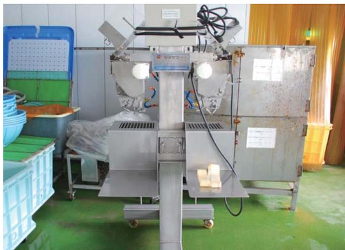
大型のサバの骨を取る中骨取り機（サバピンポーン抜き機）
