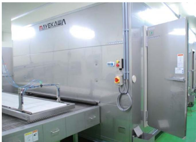
短時間で干物加工を行う連続式冷風乾燥機
