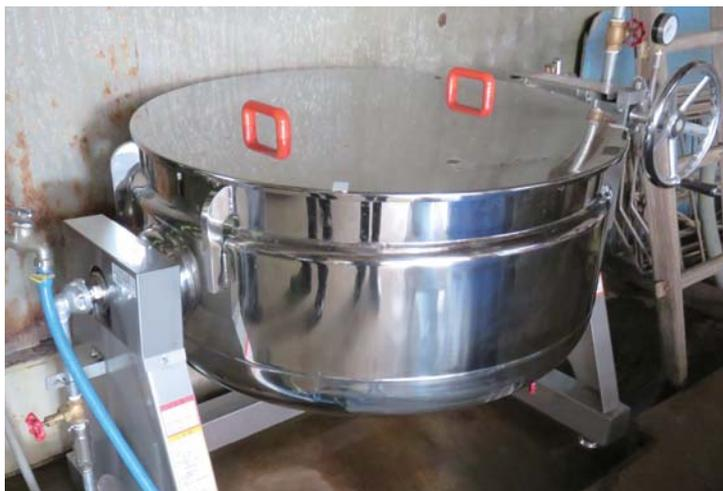
震災前に使用していた釜は少量をゆでるのには向かないため、導入した回転式蒸気釜沸騰も短時間でできるためコスト面でもメリットが大きい
