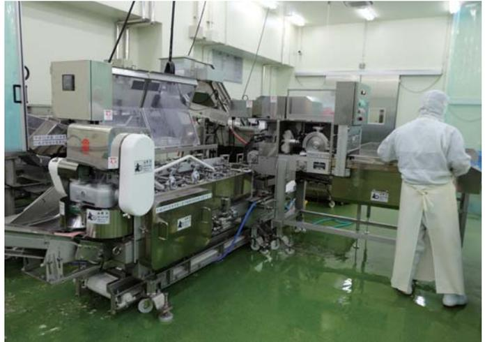
腹骨取り三枚卸機。サバフィーレを加工生でも冷凍のものでも使える、という点が導入理由のポイント
