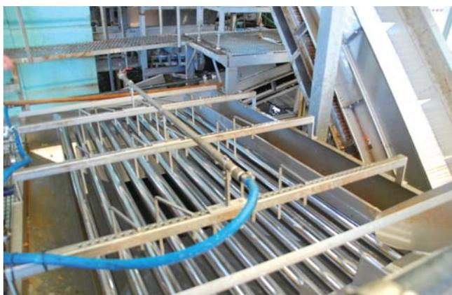
この選別機に魚を流し込むと、小さな魚はバーの間をすり抜けて下に落ちていく
