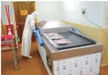
スーパーなどの取引先から個別包装の要望を受けて導入した真空包装機
