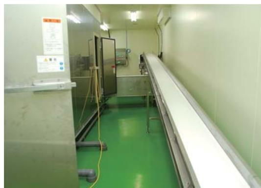
加工した干物はフリーザーコンベアで冷凍庫に運ばれる
