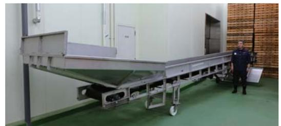
カツオ処理用 1.5 トンホッパー汲み揚げコンベア付以前は人力で運んでいたが、当機で冷凍倉庫からコンベアでトラックまで積めるため、大幅な省力化を図ることができた
