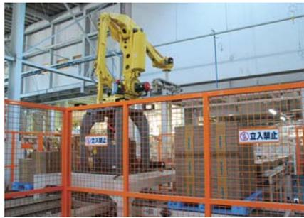
ダンボールの自動供給ロボット
