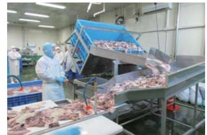
解凍した原料をラインへ投入する工程の機械化により省人化を図った
