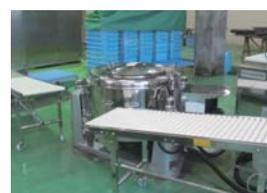
導入した脱水機と他の機器をコンベアで連結
