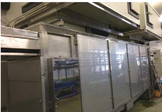
強制冷却型ちくわ放冷機
