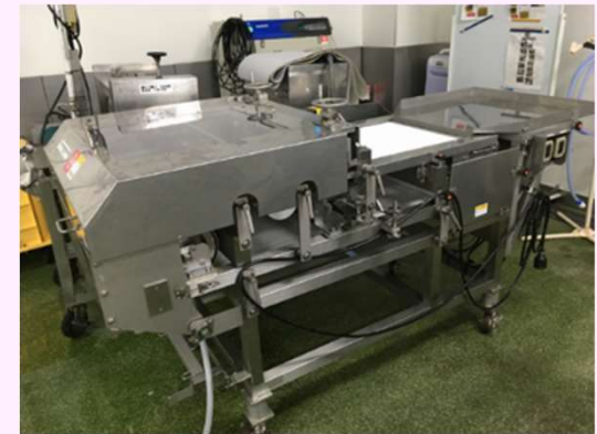
▲ サニタリー仕様の筋入れ機
