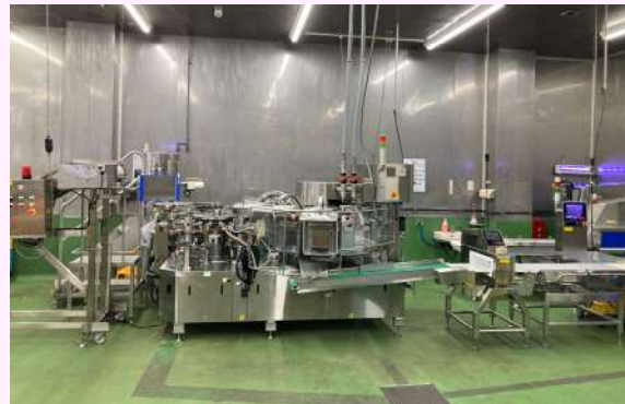
▲ 液充填、異物・重量確認作業が自動でできる自動包装ライン
