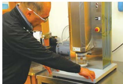
新型の卓上真空キャップ巻締め機により 2.5倍から3倍の省人効果がある
