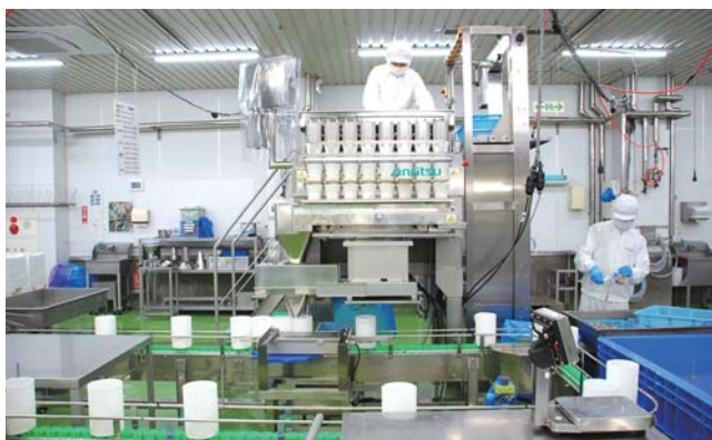
調理済みの食材を1パックの分量に分けてくれる コンピュータスケール
