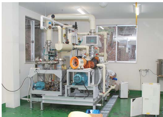
カキの殻を粉碎するための大型機械
