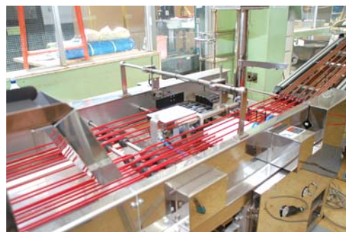
海苔の貼り合わせ機。2つのラインで流れてきた海苔を中央でサンドする
