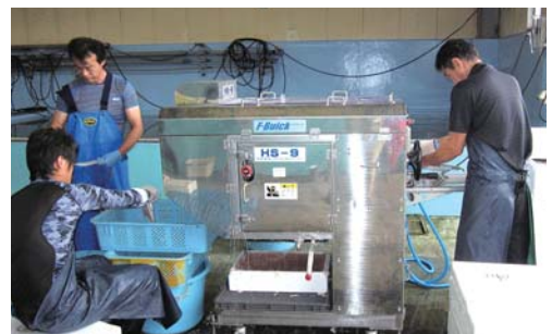
作業員（写真右）が機械にアナゴを投入すると、開いた状態にカットされて出てくる （写真はアナゴの加工機が導入された当時のもの）
