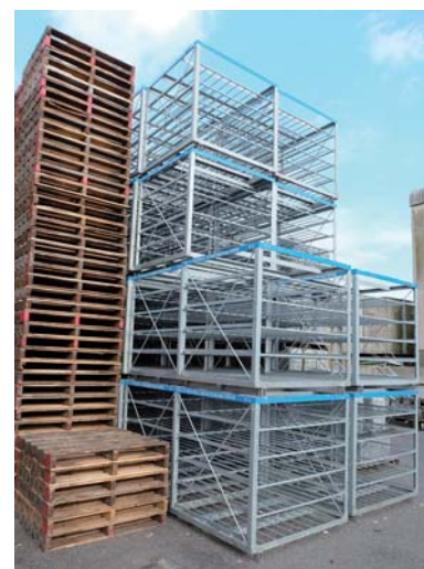
大型魚用の冷凍棚 サバなど中型魚を凍結する棚よりも、幅が広がっている
