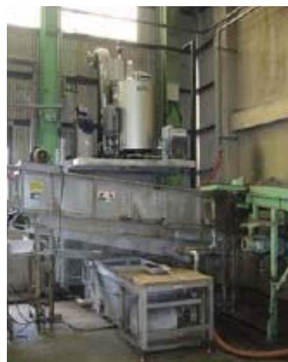
ボイラーで沸かしたお湯をかけることで、 脱パン作業を省人化、商品の破損も防ぐ
