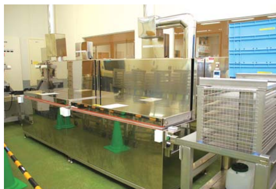
一度に 100 キロまで凍結可能なアルコールブライン凍結機
