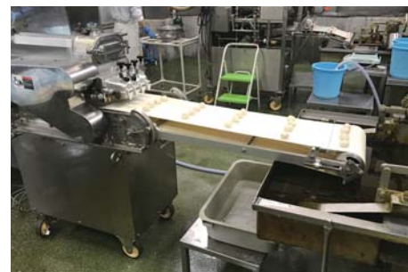
新商品開発のために導入した球天形成機
