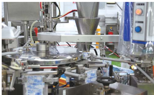
コンピュータスケールで計量された後、自動包装機で 袋詰めにする
