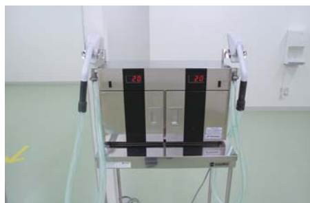
作業着に付着した小さな埃を吸い取る作業着ダストクリーナー
