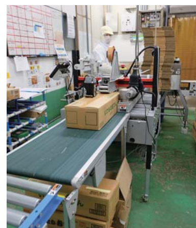
商品が箱詰めされた段ボール上下を自動で封函するカートンシーラー機
