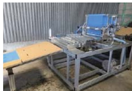
箱詰めした魚の乾燥を防ぐために ビニールかける工程を機械化
