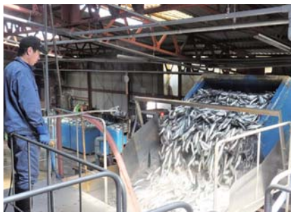
スカイタンク回転機 フォークリフトで運んだ原料をラインに送る
