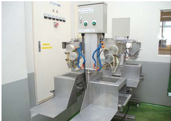
サバの骨抜き機による時間短縮で、より新鮮な状態での出荷が可能に
