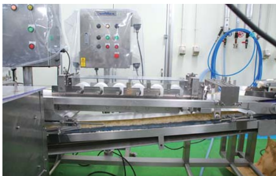
フライ用のパン粉を付けるシボリングブレッター
