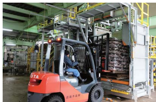
自動製品積機（左）と自動投入機。脱パン作業の機械化により大幅な省人化が図られた
