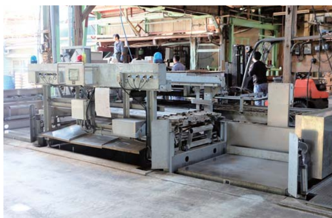
凍結用のパンを自動で積み上げるパレオート 4人で行っていた作業が2人できるようになった
