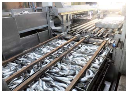
搬送コンベア パンを積み替える作業もなく一連のラインのまま凍結へ
