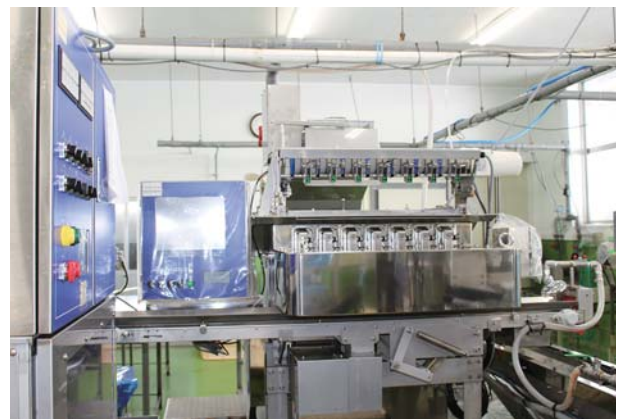
支援事業で導入した計量機、結束機のライン
