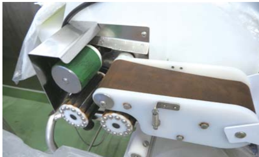
芯取り器は、熟練の職人の3倍ほどの作業スピードで、「従業員が慣れば慣れるほど、スピードがアップする」優れもの。ナイフを使わずに芯を引きぬくため、ケガをしにくいことも導入の決め手になった
