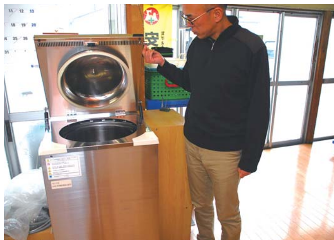
全自動小型高温高圧調理機でレトルト製品も作れるように
