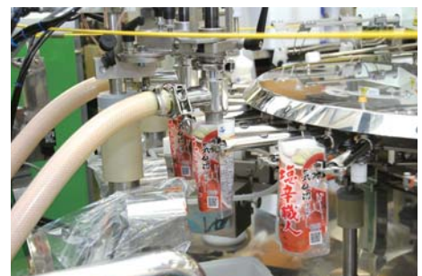
従来の充填機は充填口が一つだったが 導入機材では二連式に
