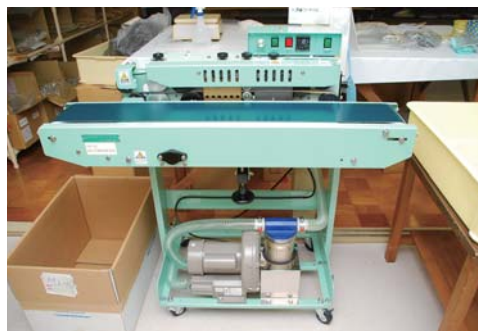
製品の入った袋を真空脱気しながら封をするセミオートシール機
