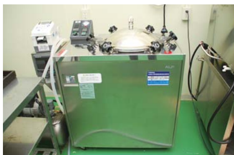
温度管理用の記録装置も備えた レトルト加工機
