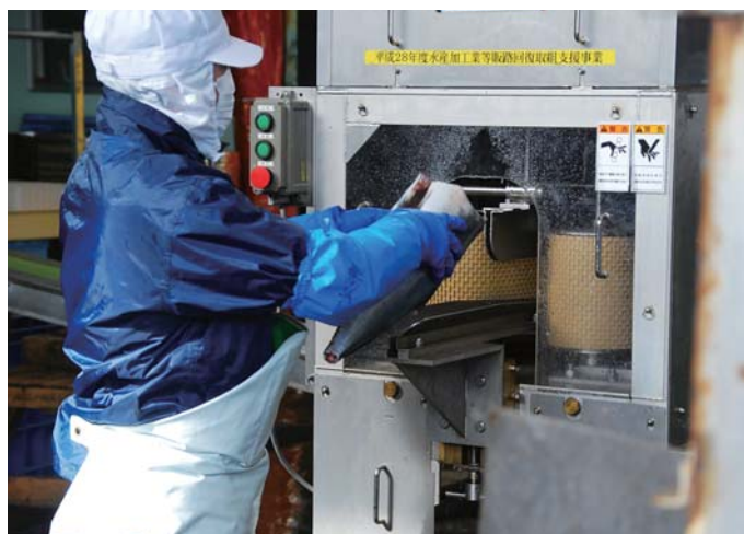
頭と尻尾、内臓を取り除いた魚をフィーレマシンに通す
