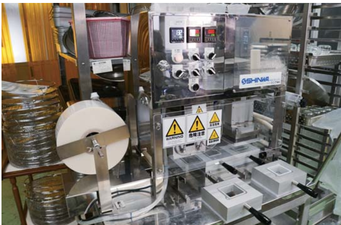
カップシーラーを使って新商品の試作が進められている
