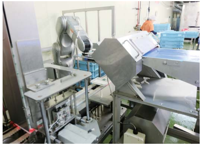
盛り付けラインのカッター部分と、トレー供給装置、盛り付け用のロボットアーム部分
