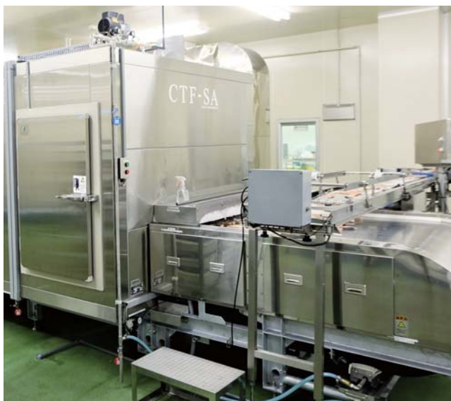
切身にしたサケを同一のラインでトンネルフリーザーに。 約-40℃に管理された冷凍庫で急速冷凍させる
