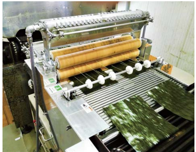
「焼く」工程と「タレを塗る」工程を連続で行う味付け装置
