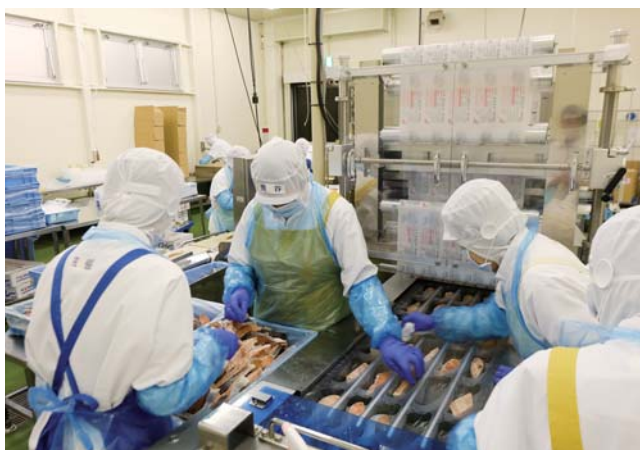
個包装、少量パックのニーズに合わせた深絞り真空パックにした商品。 個別グラム数の差が生じない切身にすることで、パッケージの際の作業効率化が図れる
