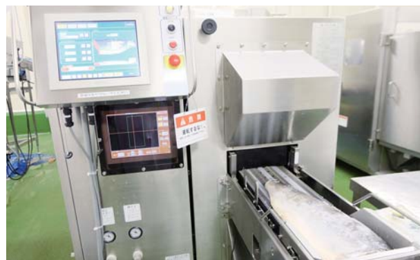
マイコン型自動切身機。画像で魚体の形を感知。どの角度で切っていけばよいかを判断、高速で切身にする
