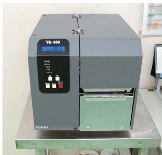
製造情報をシールに印字する一括表示印字機
