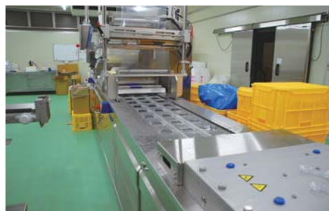
深絞り包装機により鮮度を長く保てる製品も作れるようになった
