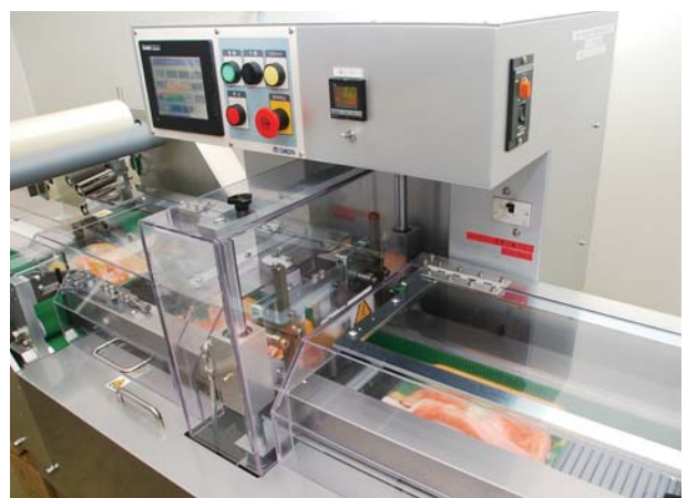
上げ底タイプのトレーにも対応しているトレー自動包装機
