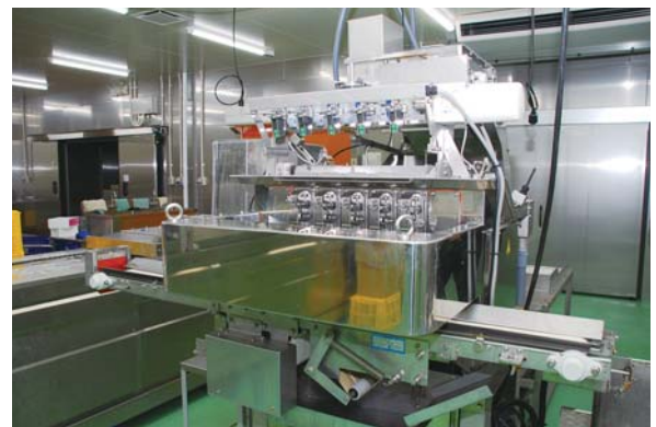
計量作業を正確かつ迅速に行うことができるコンピュータースケール
