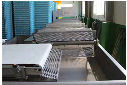
洗浄コンベア。エアで水分を飛ばせるのでドリップも出にくくなった
