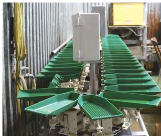
重量選別機の導入で正確に重量を計測できるようになり、取引先からの信頼度が上昇
