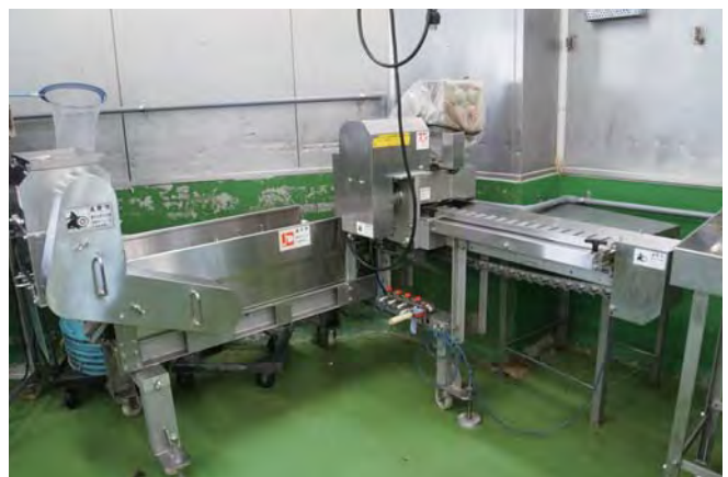
ヘッドカッター連動フィレマシの導入で作業効率が向上
