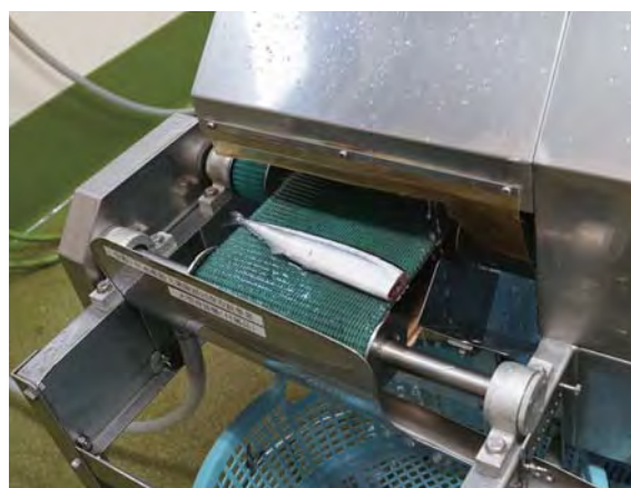
魚の骨抜きと開き加工を同時にしてくれる大型骨抜き機
