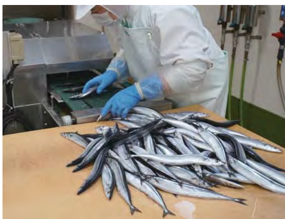
魚の骨抜きと開き加工を同時にしてくれる大型骨抜き機
