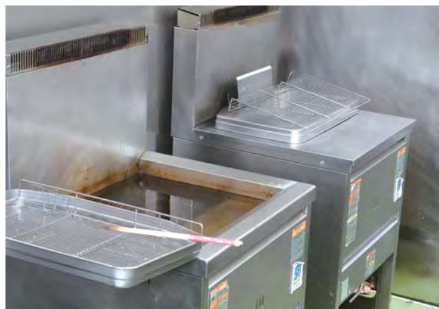
自動フライヤーとスポンジ式脱油機一式（左）と従来のフライヤー（右） 以前はこの油調の行程に最低3人必要だったが、導入後は1人になり、省人化と総作業時間の短縮化が図られた。
