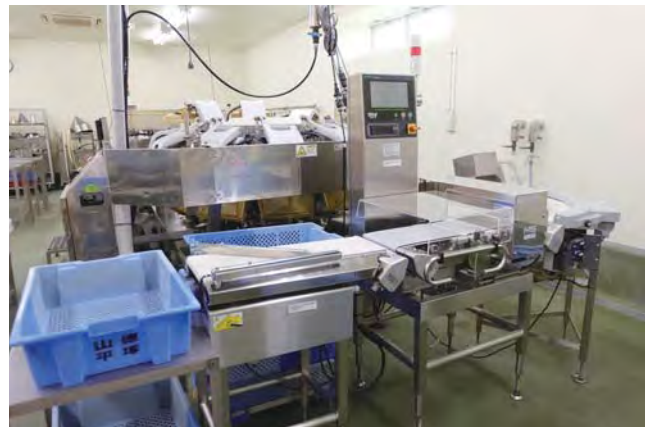
作業効率アップのため導入した金属検出機付き重量選別機一式。 これまで手作業で行っていた作業の省人化、 スピードアップが図られた
