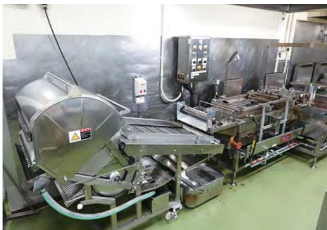
自動フライヤーとスポンジ式脱油機一式（左）と従来のフライヤー（右） 以前はこの油調の行程に最低3人必要だったが、導入後は1人になり、省人化と総作業時間の短縮化が図られた。
