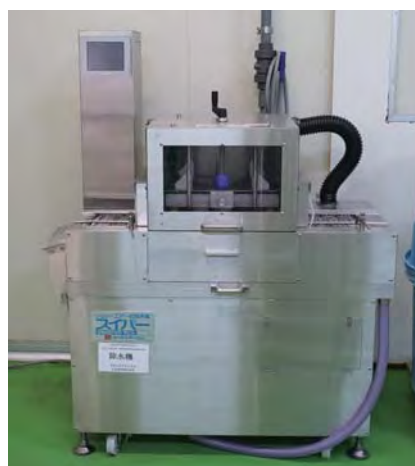
作業行程で付着したパッケージ表面の水を風で飛ばす除水機
