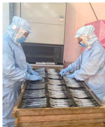
新しく導入したエアコンにより工場の温度がむらなく一定に。傷みにくい環境にすることで製品のツヤが増す
