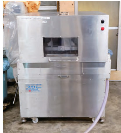
360度から風を吹き付け、水を乾かす除水機。大幅な省人化と生産性の向上が図られた
