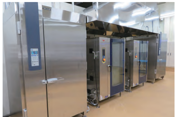
写真中央のスチームコンベクションオーブンと両脇に置かれたプラスチックラ。調理後、急速に冷やすことで、菌の増えやすい温度帯に留まる時間を短くする。隣同士に置くことで、動線が限りなく短くなり、作業負担も軽減された。
