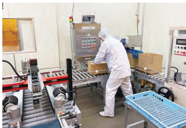
トンネルフリーザー搬送ライン（左）。製函機と封函機（右）も併せて導入したことで、ハマグリなどの貝類冷凍製品の大幅な効率化を実現
