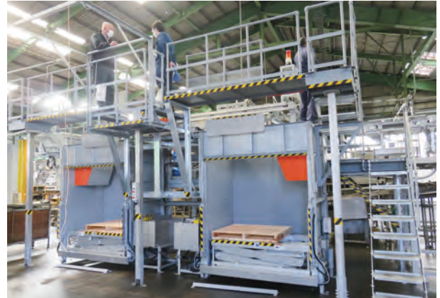
2ラインへのパレット積み作業が自動でできるようになった
