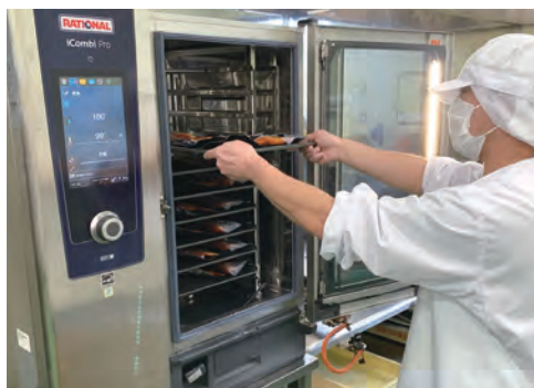
導入したスチームコンベクションオープン
