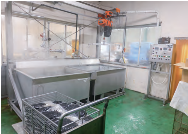
半自動殺菌機。加熱槽や冷却槽への搬入、搬出をチェーンブロックで行う
