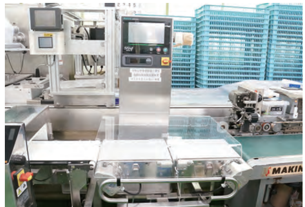
正確な重量測定により品質保持にも寄与している ウェイトチェッカー
