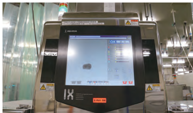
X線で瞬時にチェックし、異物の入ったカキは重量分別の手前で除去される
