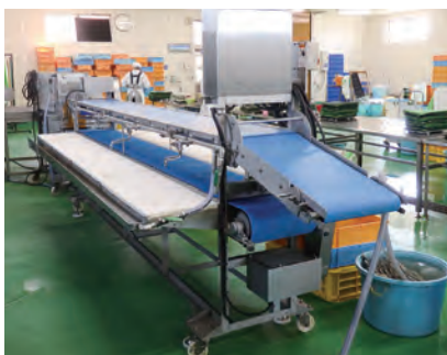
新たに導入した作業台付二段コンベア。既存の商品にも流用でき作業効率が上がった
