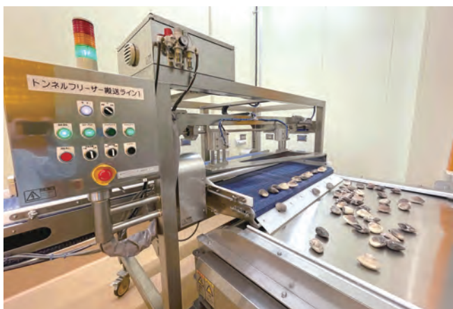
トンネルフリーザー搬送ライン（左）。製函機と封函機（右）も併せて導入したことで、ハマグリなどの貝類冷凍製品の大幅な効率化を実現
