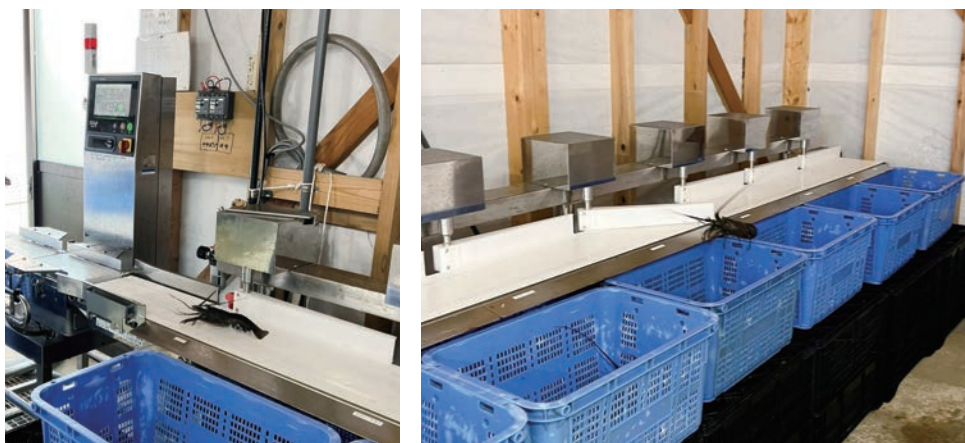
重量選別機により自動でサイズ選別されるようになり、効率化・省人化が進んだ
