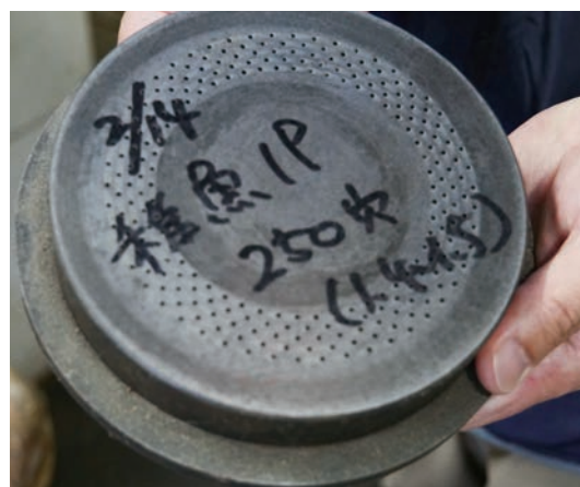
ペレットを形成する際に使われる器具。 穴の大きさによってペレットのサイズが決まる
