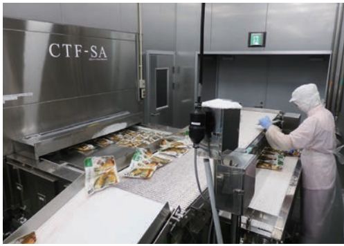
トンネルフリーザーの導入で急速冷凍が可能になり生産性と品質の向上が実現した
