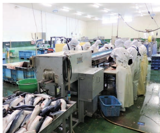
ヘッドカッターと三枚おろし機で省人化、生産効率化に成功
