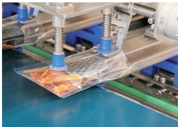
袋詰めを機械により自動化。 袋にうまく収まるように何度も調整された
