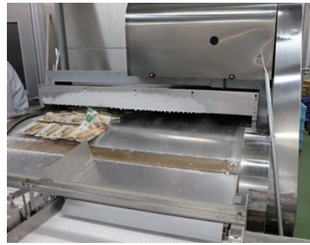
トンネルフリーザーの導入で急速冷凍が可能になり生産性と品質の向上が実現した
