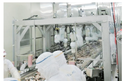
定量充填作業用省人化システム
