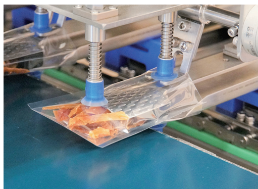
袋詰めに機械により自動化。袋にうまく収まるように何度も調整された
