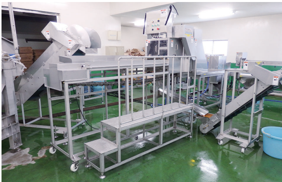
サバフィレのラインのうち、バケット式ヘッドカッター
