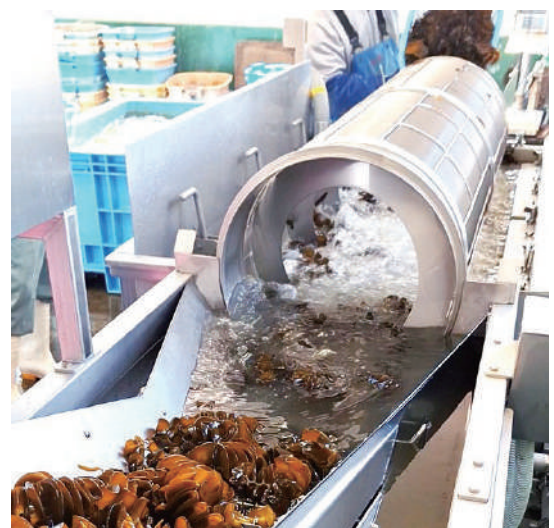
メカブの洗浄も行うメカブ連続式異物除去洗浄機
