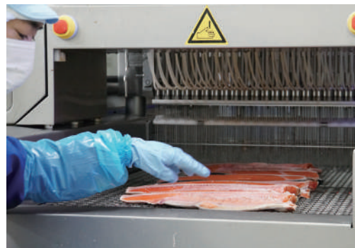
塩水注入を行うフィッシュインジェクター。 半身のサケを機械に流し込むだけであっという間に注入が終わる
