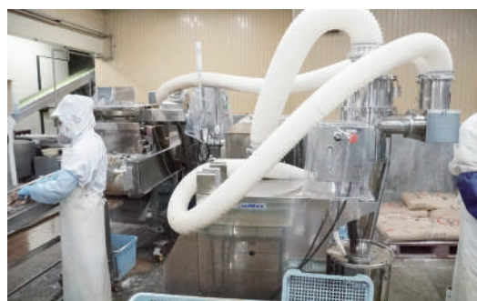
粉つけ機に接続している粉補給機と集塵機
