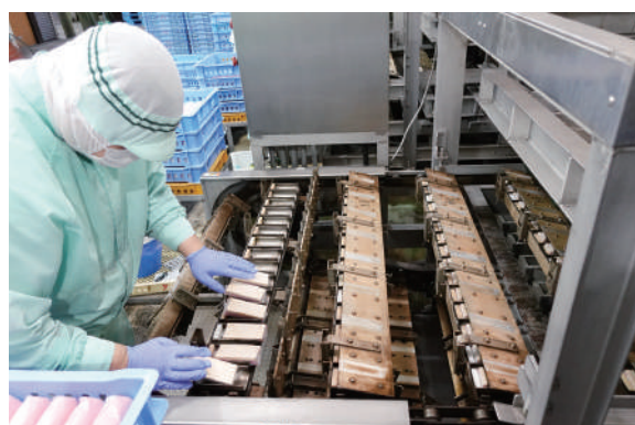
105g の板かまぼこ製造用のリテーナ缶にスペーサーを導入し、従来ある機器を再利用して取引先のニーズに合う商品の生産能力を大幅にアップさせた
