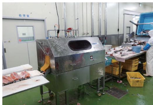
大型の魚を半分にカットする大型センターカット機
