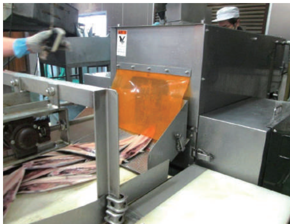
新たに導入した導入した中型三枚卸機
