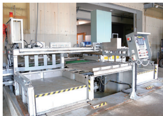
パレットへの製品積み替えを行う自動製品積機
