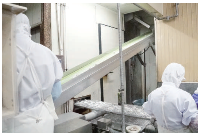
現在使用しているスパイラルフリーザー。下部コンベアから食品が入り、上部から凍結済み製品が流れてくる仕組み
