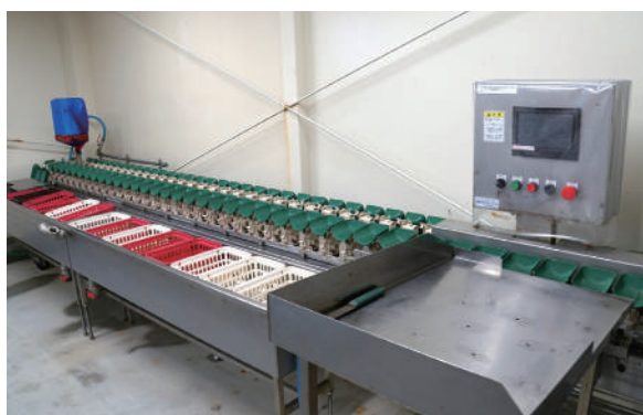
コンピューター式の重量選別機の導入により 計量の処理速度は倍近くに
