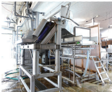
イントラベルトコンベアの導入により、品質が向上したほか、投入口と運搬口の動線がよくなり、原料を搬入しやすくなった
