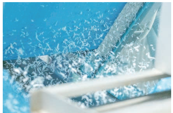
釜ゆでたしらすを風で吹き飛ばし、その中に混じるエビやカニなどを除去する
