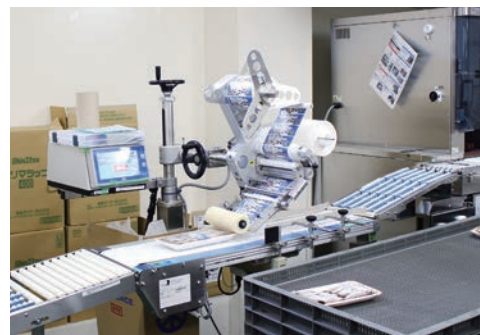
導入した自動ラベリングライン
