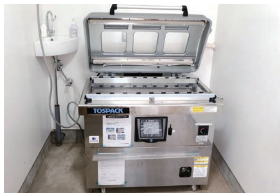
導入した真空包装機。大幅に生産能力の効率化を実現した
