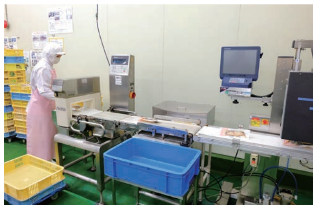
新たに導入した深絞包装機（左）とラベル機（右）。大幅な生産能力アップとなった
