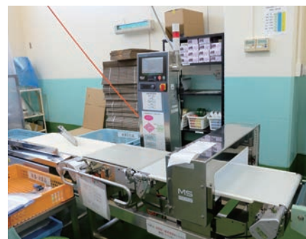
新しく導入した金探付オートチェッカー（左／6kg仕様 右／3kg仕様） 精度が上がリ製造ラインのスムーズな稼働が可能になった
