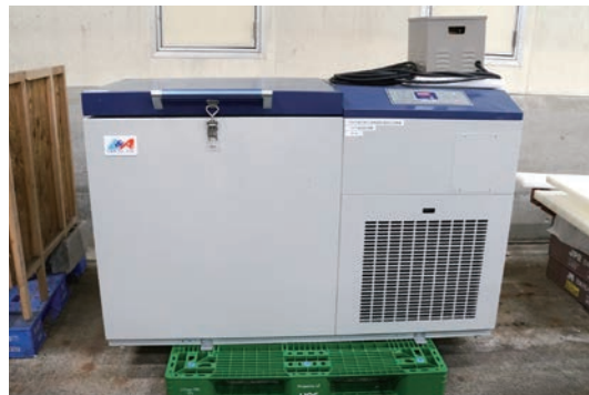
マイナス 150 度で魚を凍らせる超低温凍結機
