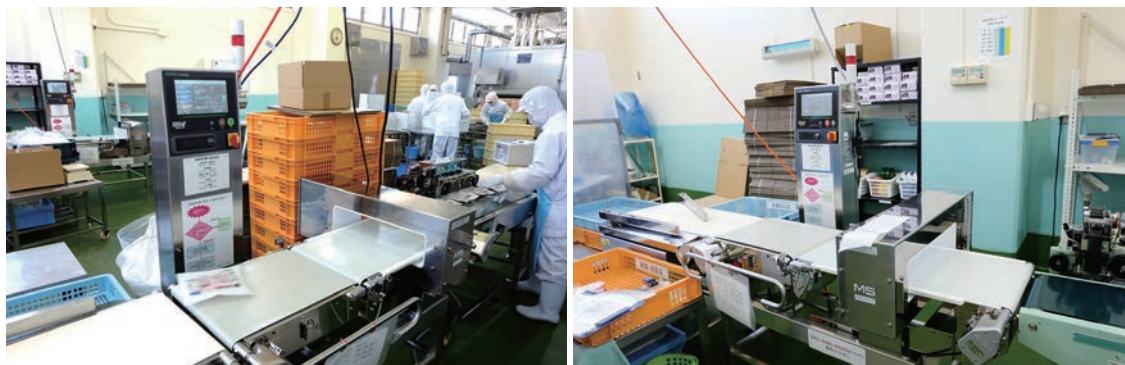
金探付オートチェッカー（左／6kg仕様 右／3kg仕様） 精度が上がリ製造ラインのスムーズな稼働が可能になった
