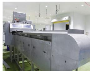
イワシ引き抜き式胴切付ヘッドカッター
