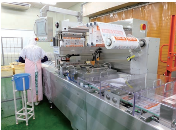
新たに導入した深絞包装機（左）とラベル機（右）。大幅な生産能力アップとなった
