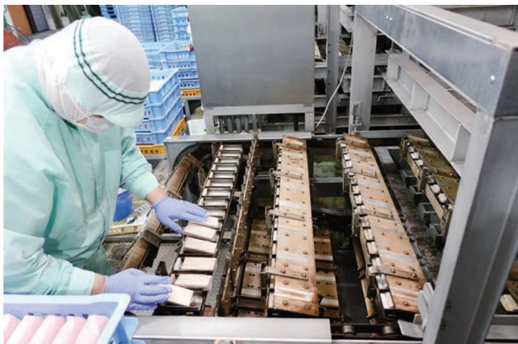
105gの板かまぼこ製造用のリテーナ缶にスパーサーを導入し、取引先のニーズに合う商品の生産能力を大幅にアップさせた
