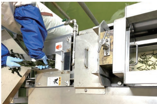
カット作業を自動化させた若布茎等細切り機
