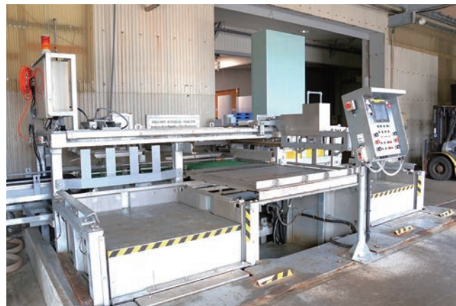
パレットへの製品積み替えを行う自動製品積機
