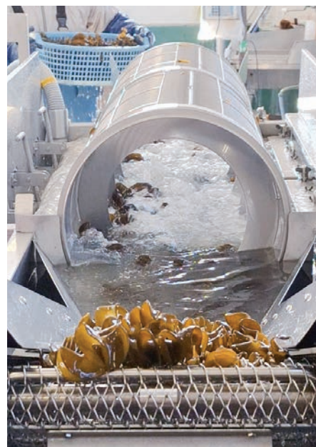
メカブの洗浄を行う メカブ連続式異物除去洗浄機
